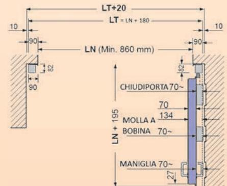
Sezione orizzontale 1 anta con telaio tubolare
