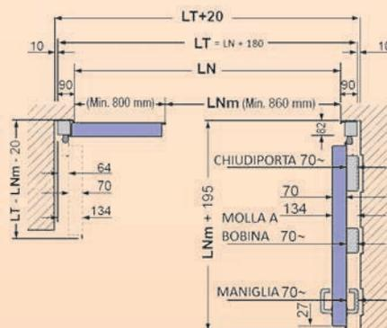
Sezione orizzontale 2 ante con telaio tubolare
