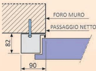
Dettaglio del telaio tipo "tubolare"
