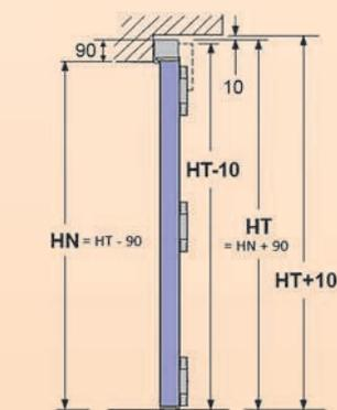
Sezione verticale 1 e 2 ante con telaio tubolare
