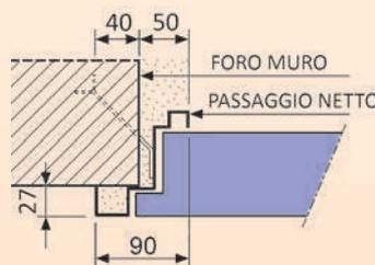
Dettaglio del telaio tipo "Z"
